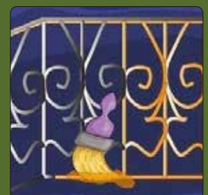
4. Aplikasikan cat besi / top coat sesuai warna pilihan
